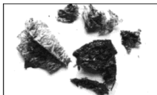
Abbildung 4. Prüfung der Kompostierbarkeit des Copolyesters Ecoflex nach DIN V 54900, Teil 3.
